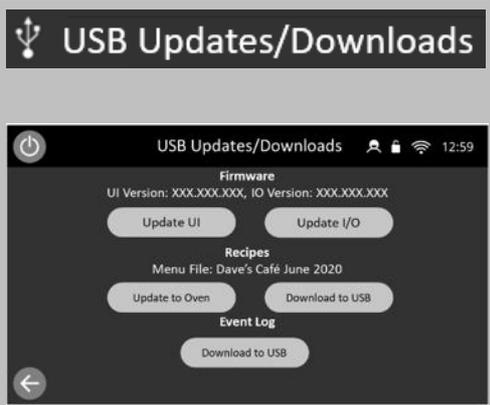
Подключите USB-накопитель, как описано в следующем разделе 8.2.7, и выберите «Обновления USB» для загрузки микропрограммного обеспечения и программ меню печи вручную или для копирования любых файлов с прибора на USB-накопитель;
