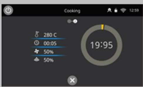
Производится обратный отсчет времени приготовления для каждого этапа программы.
