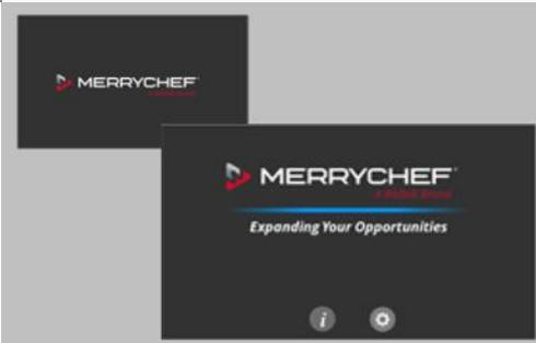
На экране EasyTouch® прокручивается изображение брендов Welbilt. После загрузки появится экран-заставка Merrychef, на котором можно выбрать ярлык «Информация» или «Настройки». Если оставить экран в режиме ожидания, он автоматически перейдет в раздел предварительного нагрева/параметров предварительного нагрева.
