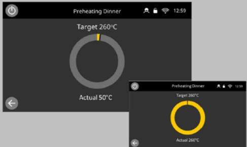
Во время предварительного прогрева на дисплее отображается последовательность нагрева камеры до заданного значения температуры. Чтобы остановить нагревание камеры, нажмите стрелку назад в левом нижнем углу экрана. (При этом вы вернетесь к предыдущему экрану).
