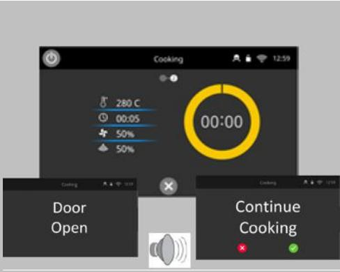
По окончании приготовления автоматически отобразится экран «Приготовление завершено», и раздастся звуковой сигнал. Открывание дверцы печи во время приготовления останавливает программу приготовления, при этом появляется предупреждение. Закрывание дверцы позволит пользователю продолжить или отменить действия программы приготовления.
