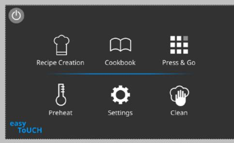
Выберите значок «Предварительный нагрев» на главном экране или кнопку предварительного нагрева в левом нижнем углу экрана, если печь находится в режимах «Быстрое обслуживание» или Press & Go.
